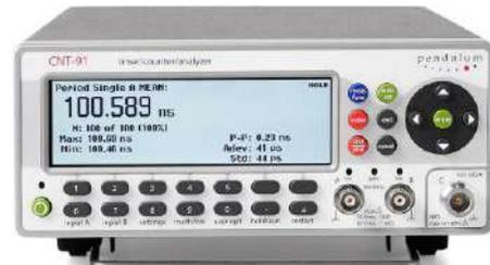
Рис. 4: На дисплее отображаются различные статистические параметры для одновременного просмотра.
